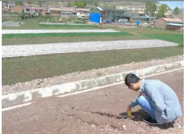
侵蚀沟现场量测流失量
